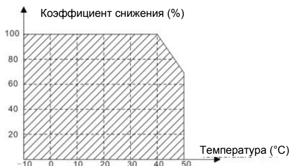
Рисунок 3-2. Снижение номинальной мощности ПЧ.
