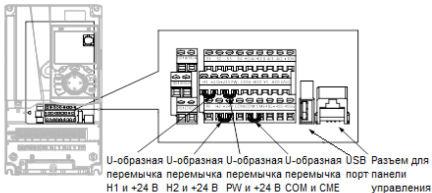
Рис 4.16 Расположение U-образных контактов
